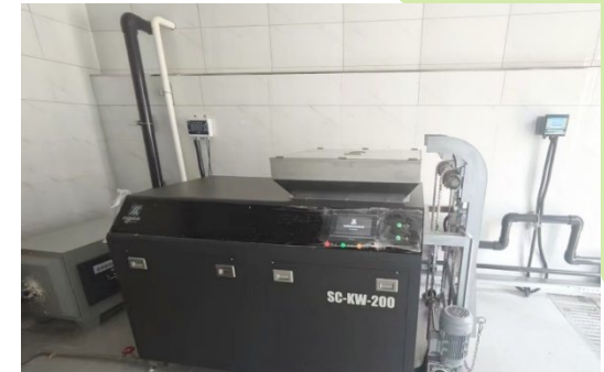
廚餘消化系統 Food waste digester
